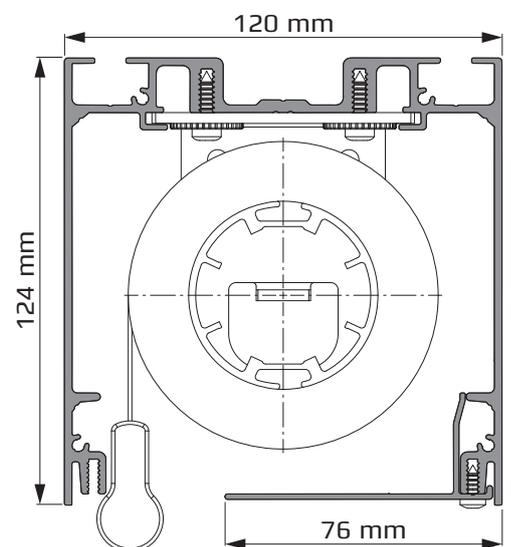
Typ 350 - Rollo Large mit Halterbefestigung und seitlicher Kettenbedienung
