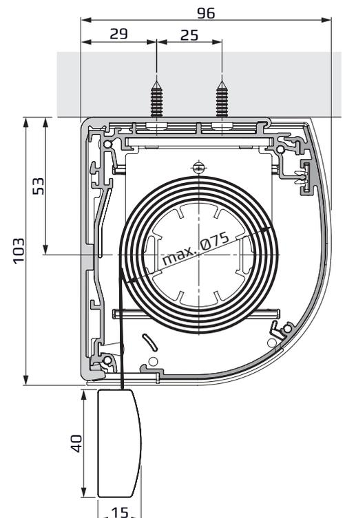
**Typ 220 - Rollo Medium Plus mit rundem Kassettenprofil und Kettenbedienung.**
