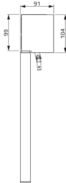
**Typ 230 Rollo Medium Plus mit eckigem Kassettenprofil und Kurbelantrieb.**
