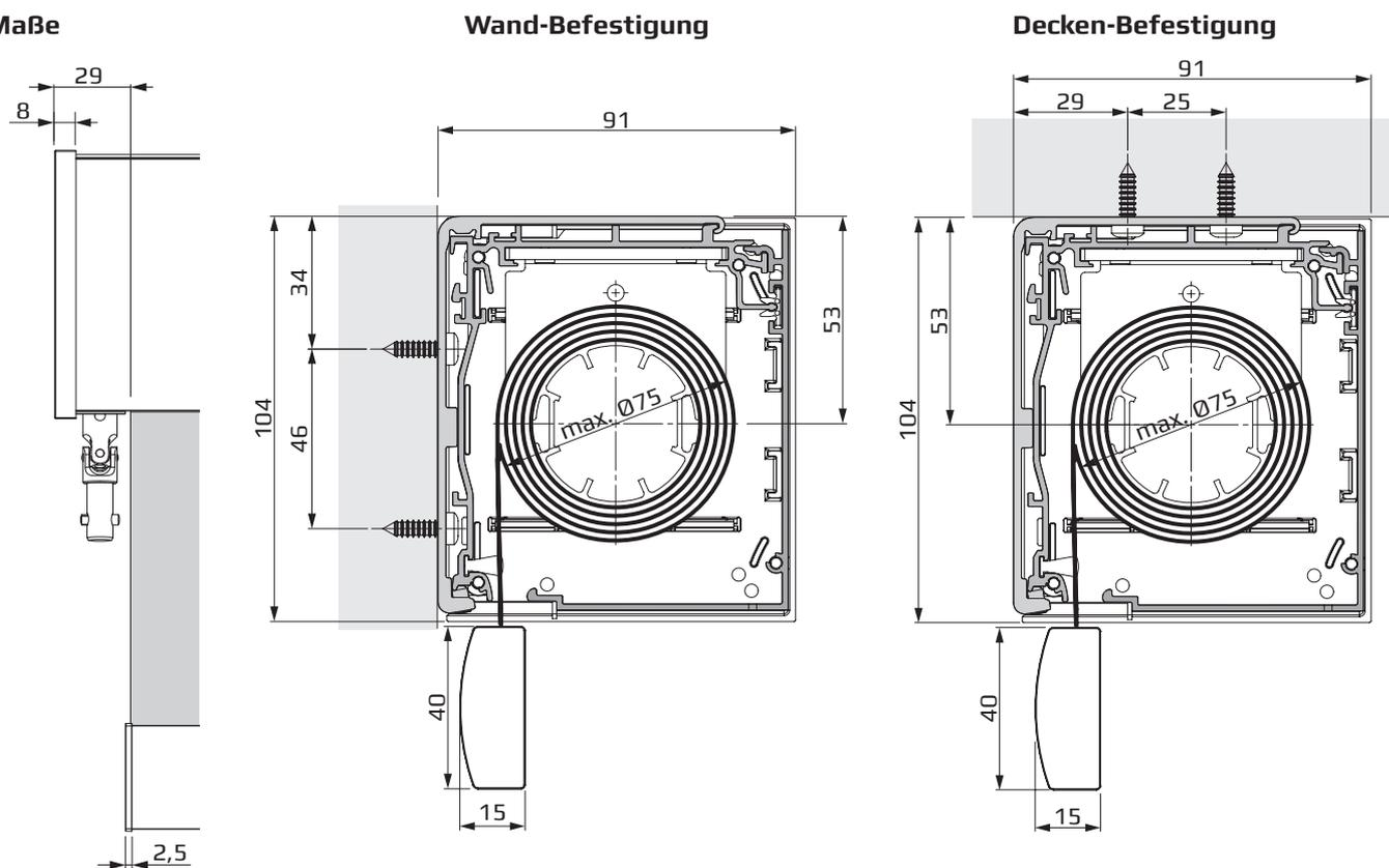
Typ 230 - Rollo Medium Plus mit eckigem Kassettenprofil und Kurbelantrieb.
