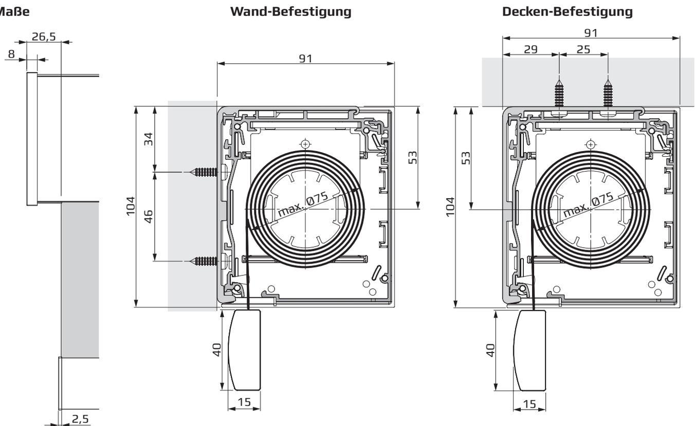
**Typ 230 - Rollo Medium Plus mit eckigem Kassettenprofil und Motorantrieb.**
