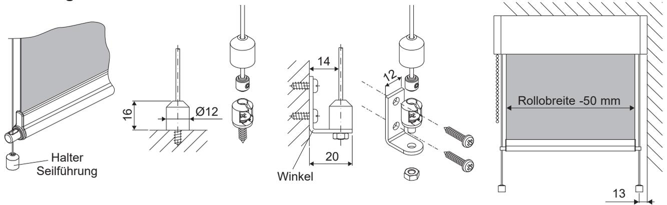
Typ 320 - Rollo Large mit rundem Kassettenprofil und seitlicher Kettenbedienung
