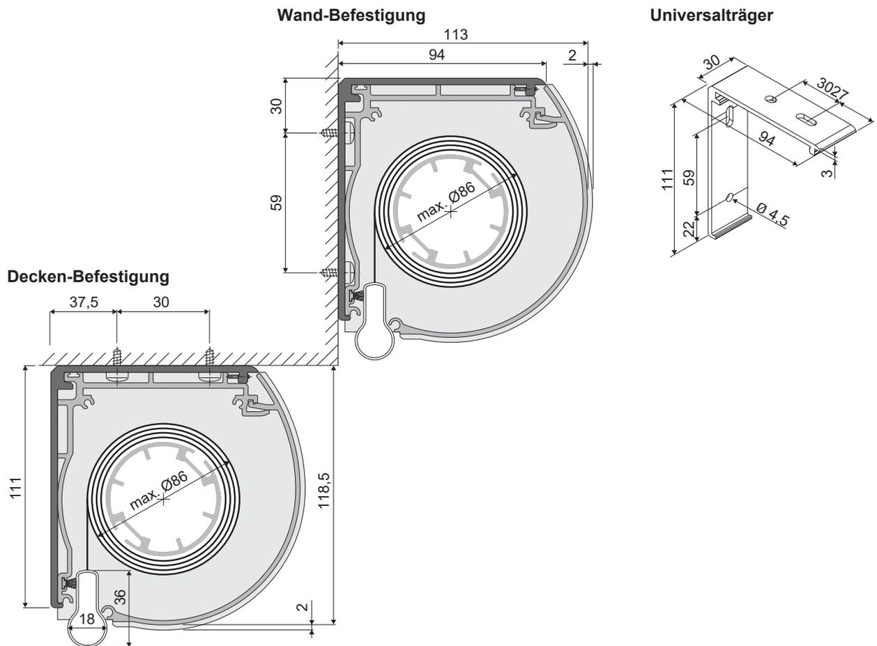
Typ 320 - Rollo Large mit rundem Kassettenprofil und seitlicher Kettenbedienung
