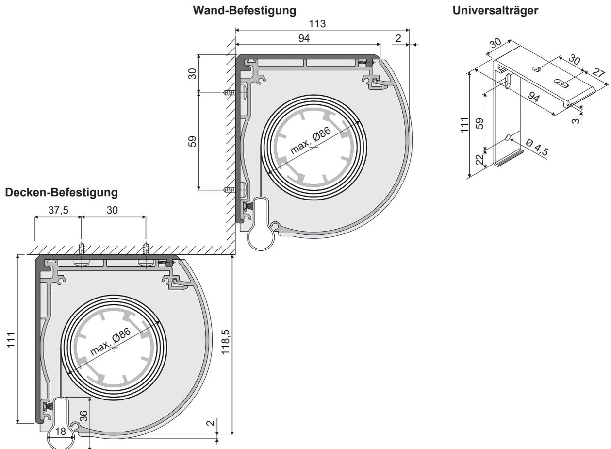
Typ 320 - Rollo Large mit rundem Kassettenprofil und Motorbedienung
