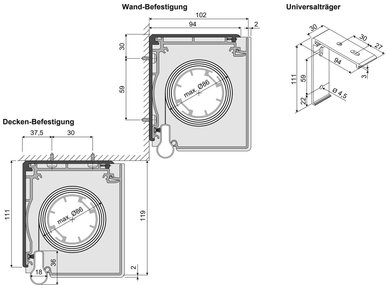
Typ 330 - Rollo Large mit eckigem Kassettenprofil und Motorbedienung
