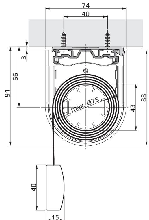
**Typ 210 - Rollo Medium Plus mit Trägerprofil und Kurbelantrieb.
