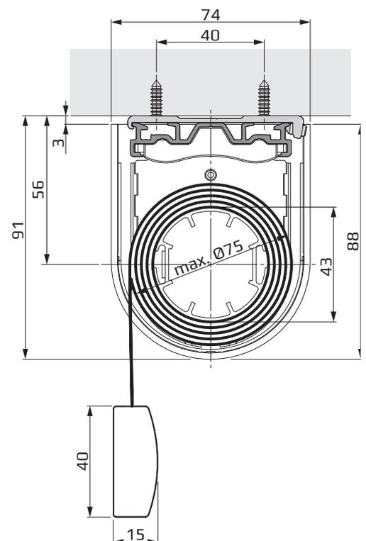
**Typ 210- Rollo Medium Plus mit Trägerprofil und Motorantrieb.
